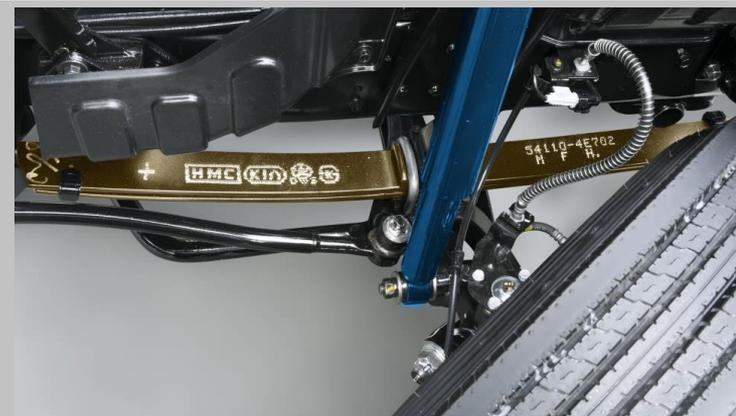
Стабилизатор (Диаметр : Ф32)
