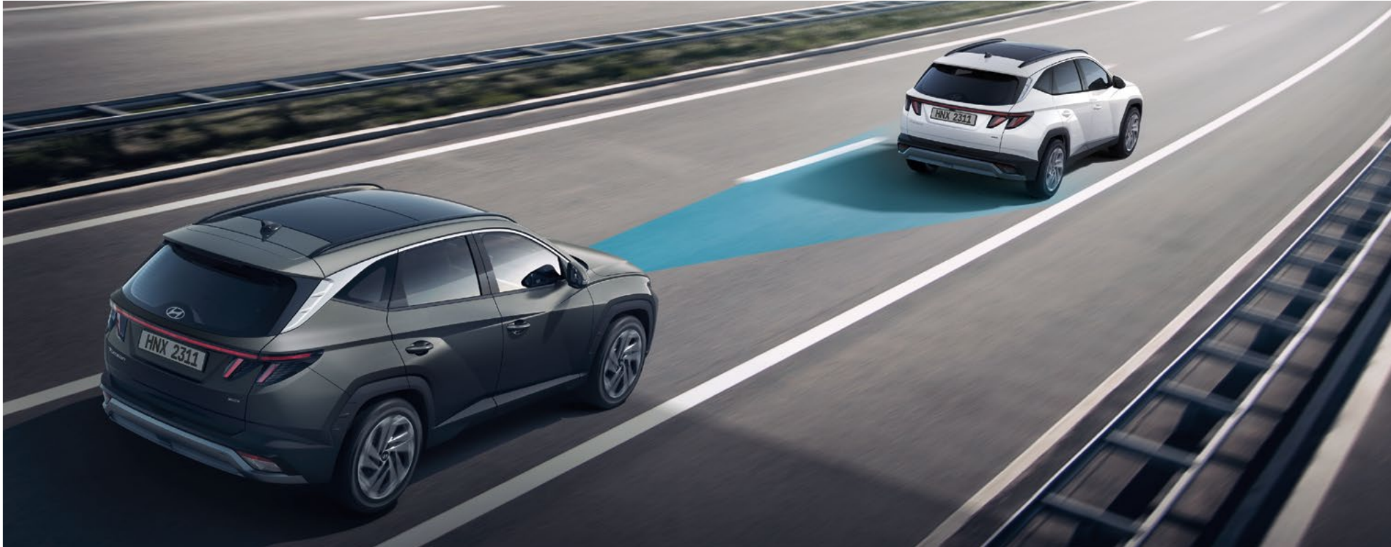
Адаптивний круїз-контроль на базі даних з навігаційної системи (N-SCC) Завдяки автоматичному контролю швидкості підтримує задану швидкість і дистанцію до транспортного засобу, що рухається попереду.
