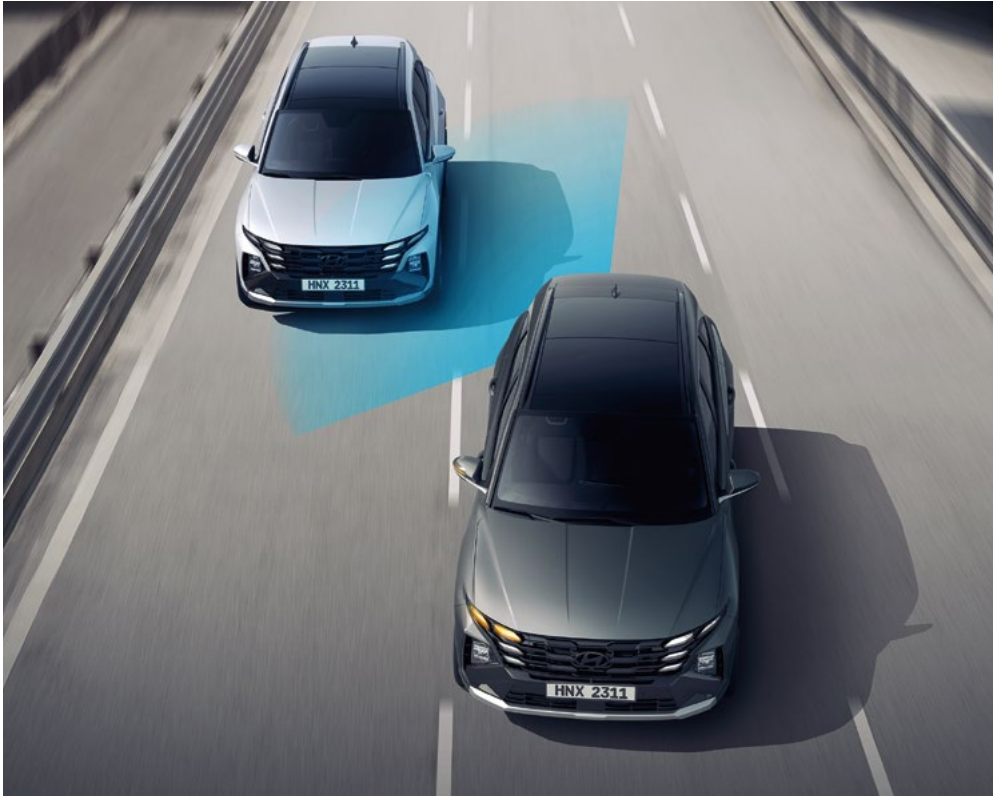
Асистент запобігання зіткненню з автомобілем в «сліпих» зонах (BCA) Виявляє транспортні засоби позаду в сліпих зонах і запобігає ризику зіткнення під час зміни смуги руху або виїзду з паралельних місць паркування, вмикаючи попереджувальний сигнал та активуючи автоматичне гальмування.
