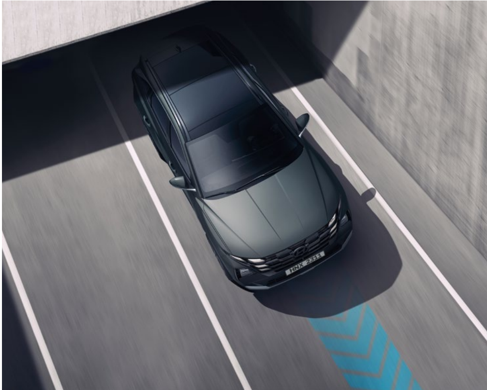
Асистент утримання автомобіля в полосі руху (LFA) Система утримує автомобіль у центрі смуги руху на швидкостях від 0 до 180 км/год на автомагістралях і міських вулицях.
